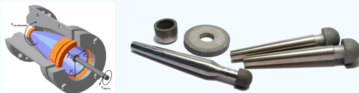
Рис. 13. Алмазные головки для внутреннего шлифования обтекателей ракет.
