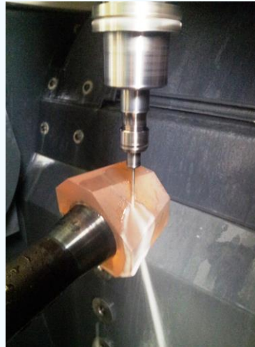
Рис.8. Сверление отверстий каналов кольцевым сверлом Ø2,4мм.
