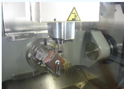
Рис.11. Алмазное сверление отверстий в корпусе из ситалла.
